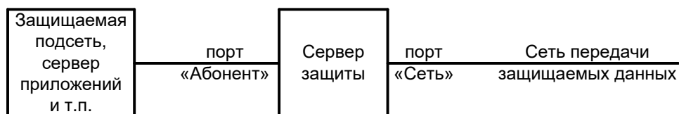
Рисунок 3 – Схема подключения сервера защиты
